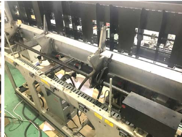
フロントテーブル・バックテーブル・インサートテーブル・ホッパーを取り外し、細部にわたり分解清掃・整備、部品交換
