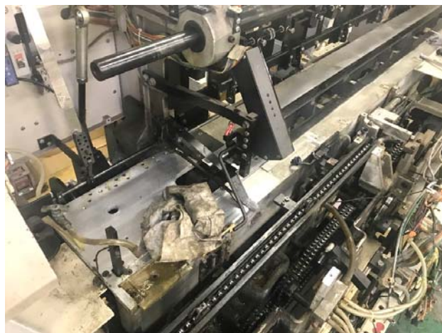
フロントテーブル・バックテーブル・インサートテーブル・ホッパーを取り外し、細部にわたり分解清掃・整備、部品交換
