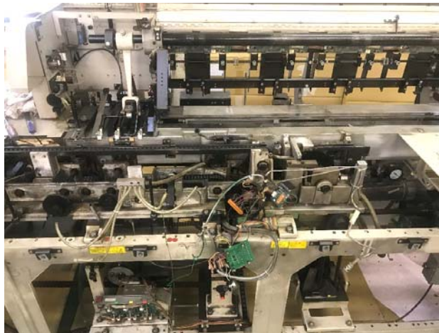
フロントテーブル・バックテーブル・インサートテーブル・ホッパーを取り外し、細部にわたり分解清掃・整備、部品交換
