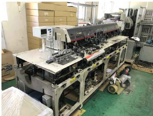
スタッカーモデルで入荷、ポンプ・モーター入替
