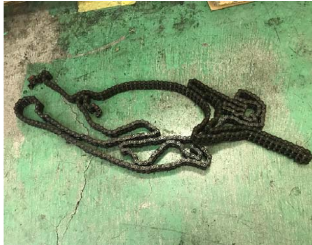
Wチェーン・プッシャーチェーン・グリッパーチェーン全て新品に交換
