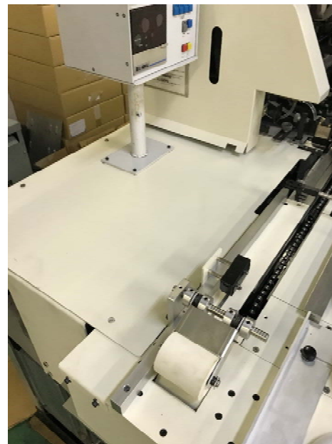
キックアウトローラー新品取付 アウトプットの仕様変更
