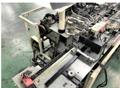
完成封筒の排出は、アドレスを下向きのまま排出、既存の下読み検査装置と連動できる仕様です。
